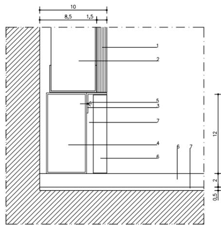
DETALLE RODAPIE EN TRASDOSADO MUROS E-1/2
